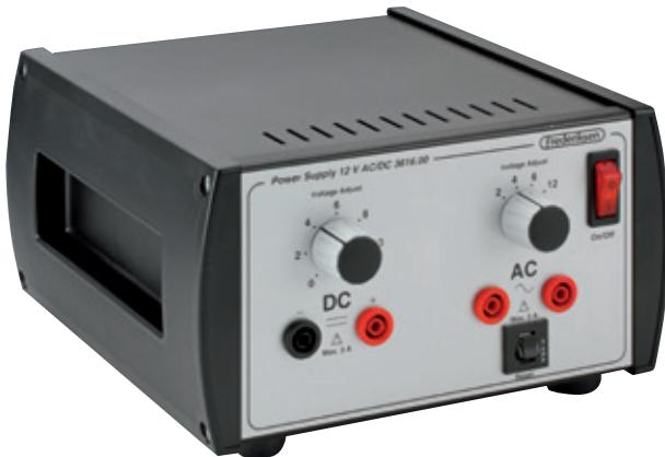
Strømforsyningen leverer en stabiliseret jævnspænding, som kan justeres trinløst mellem 0 og 12 V. Desuden leveres en vekselspænding, som kan vælges til 2, 4, 6 eller 12 V. Vekselspændingen er ikke stabiliseret.
