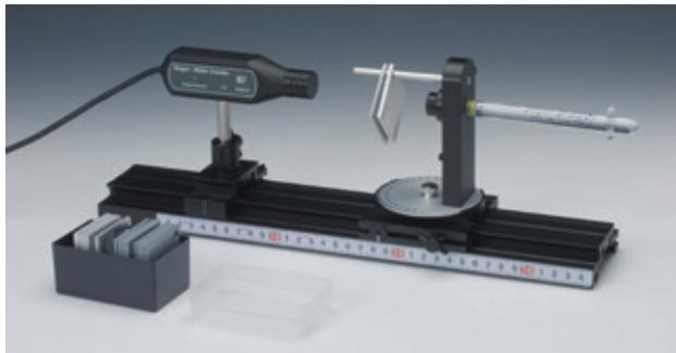
Med denne opstillingsbænk til Risøkilder og GM-rør opnås en stabil og hensigtsmæssig opstilling, som giver mulighed for at udføre reproducerbare forsøg med ioniserende stråling.
